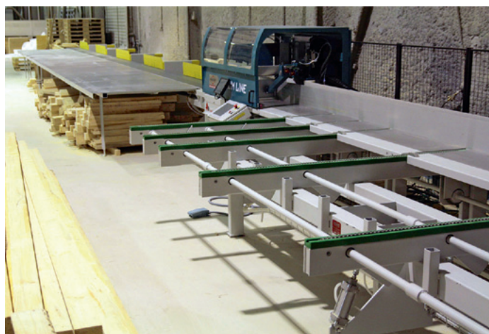
Kappanlage Slim Line 225 von Christof Reinhardt Maschinenbau hat die Produktivität beim Holzzuschnitt bei CEV Exportverpackung enorm gesteigert
